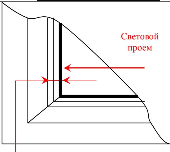
3. Необходимо учесть, что фактический габаритный размер изделия (по габаритам кронштейнов) больше ширины полотна на 38 мм, по 19мм с каждой стороны. При этом габаритным размером изделия, преданном в производство будет считаться ширина полотна.
