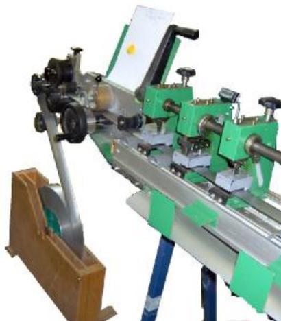
Изготовление **деревянных и пластиковых ламелей** Резка деревянных и пластиковых ламелей производится при помощи маятниковой пилы. Пробивка отверстий осуществляется по таблице представленной ниже.
