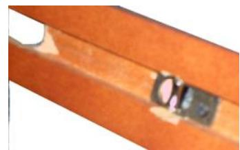
Установить механизм управления, так чтобы неподвижное колесо фиксатора комплекта механизма управления было направлено в сторону суппортов с роликами.
